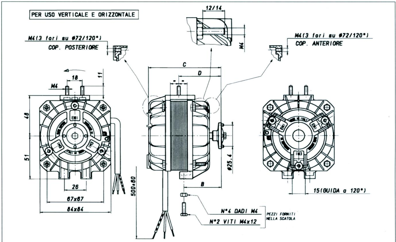
**Motori standard 230V 50-60Hz classe di isolamento "B" grado di protezione IP42**
