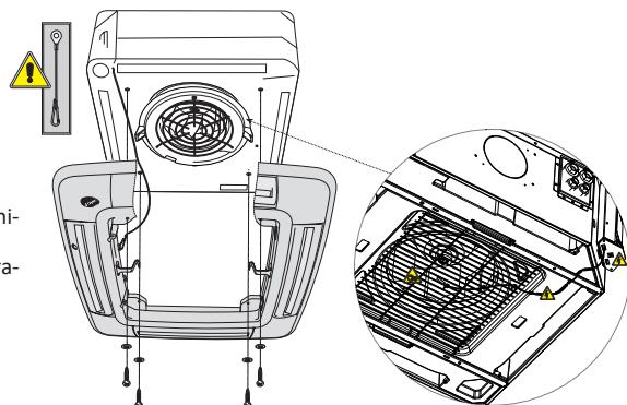
**Montaje de la sonda SA5 en los modelos FCW y FCWI:**
