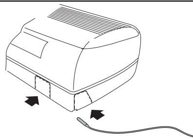
**Montaje de la sonda SA5 en los modelos OMNIA UL, ULI:**
