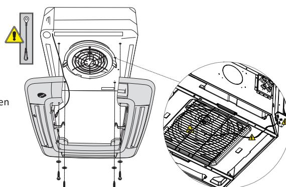
**Montage des Fühlers SA5 an den Modellen FCW und FCWI:**
